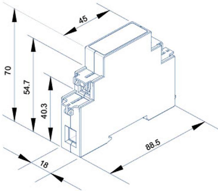
NB : Le couple en connexion directe ne doit pas être supérieur à 4.0N-m.
