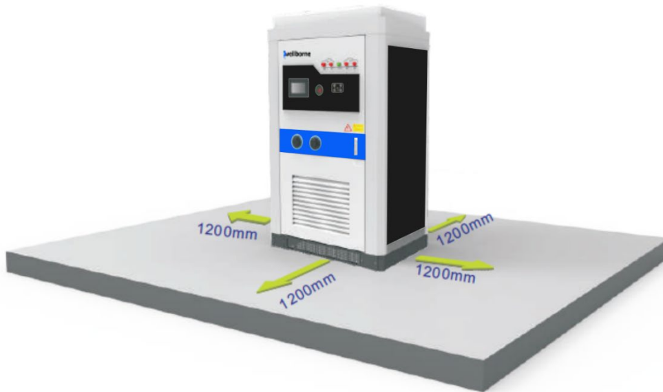
Fig 4.1.1 Illustration de l'espace d'installation
